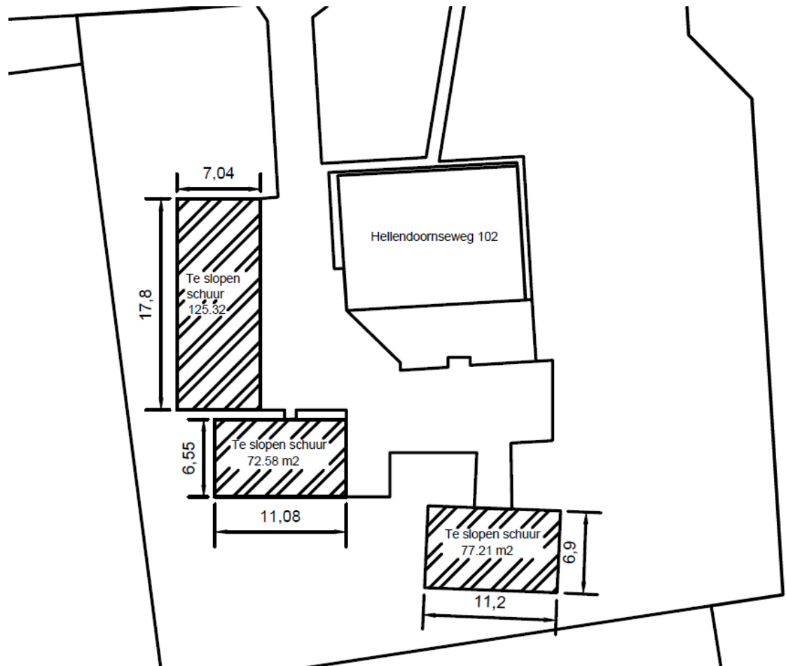
Figuur 2.3: Te slopen gebouwen
