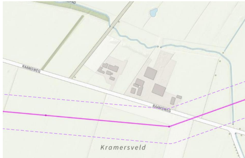
Afbeelding 15 Indicatieve magneetveldzone hoogspanningslijn
