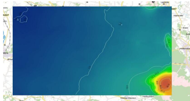
Figuur 15: Weergave grondwaterstromingsrichting
