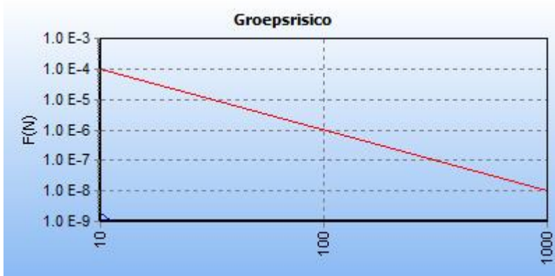
5.4 Figuur 5.4 FN curve voor 6389_leiding-N-557-34-deel-1 van N.V. Nederlandse Gasunie voor de kilometer tussen stationing 0.00 en stationing 320.00
