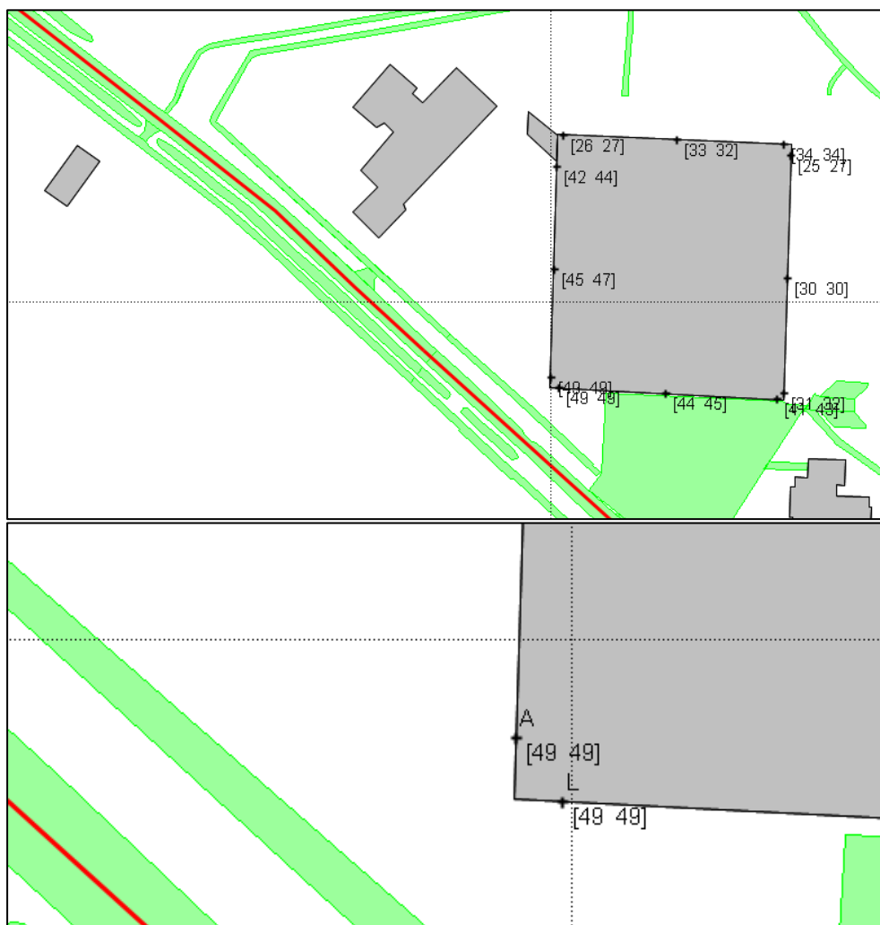
Figuur 4 Hoogst berekende geluidbelasting vanwege de Weseperweg (60 km/uur en 30 km/uur gezamenlijk) inclusief aftrek conform artikel 110g Wgh
