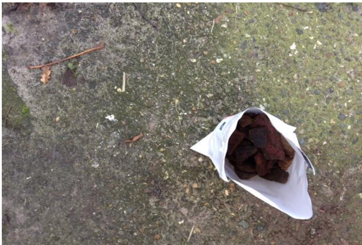
Foto 5: asbesthoudend materiaal uit G6
