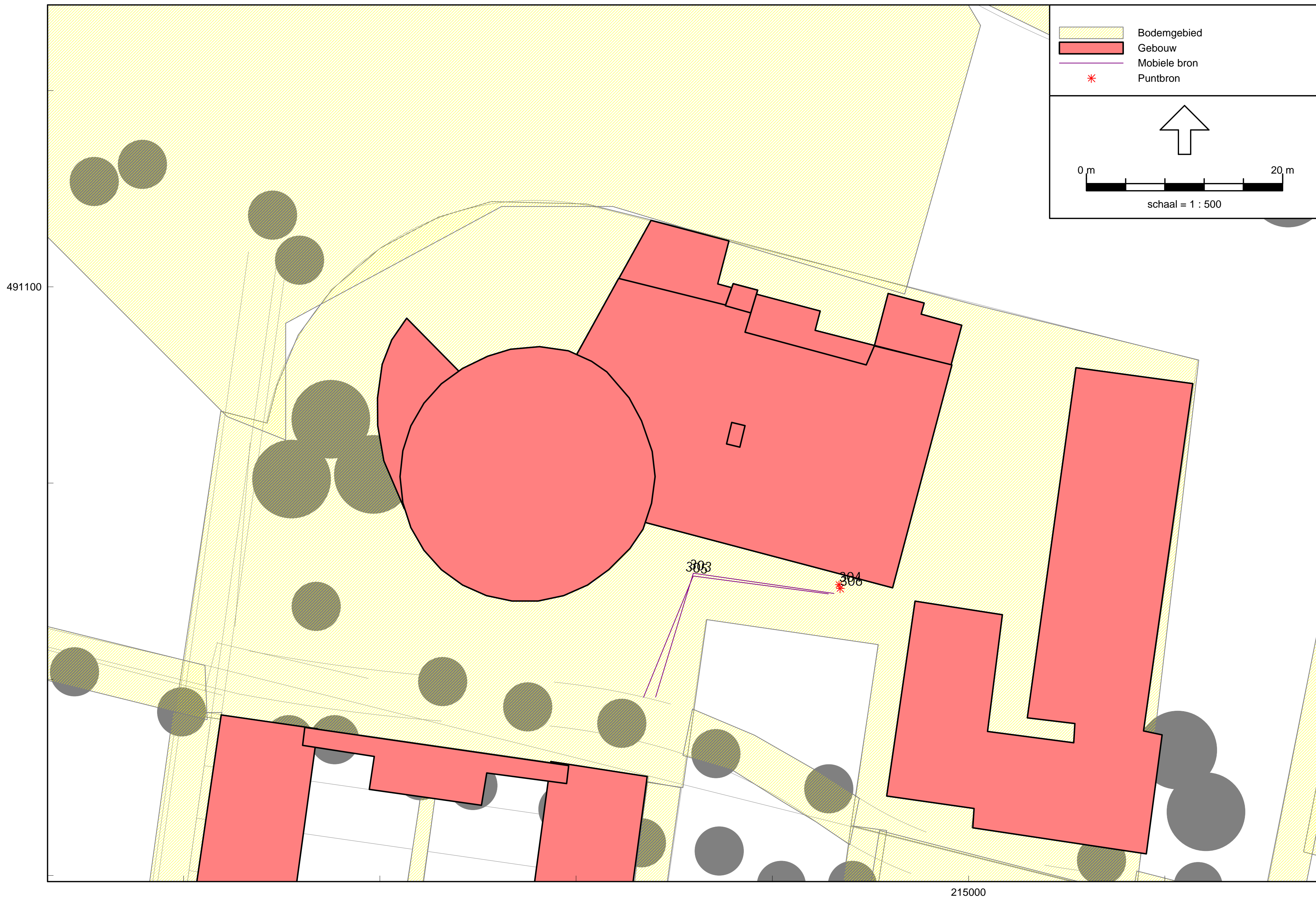
Figuur 8 Overzicht rekenmodel, ligging bronnen vrachtwagens en laden en lossen bij foyer
