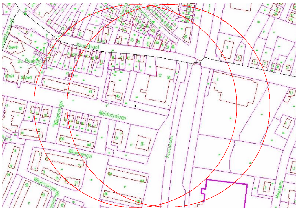
Figuur 2.1b: Omgeving van het LPG tankstation en invloedscirkels rondom het vulpunt en om de ondergrondse tank.
