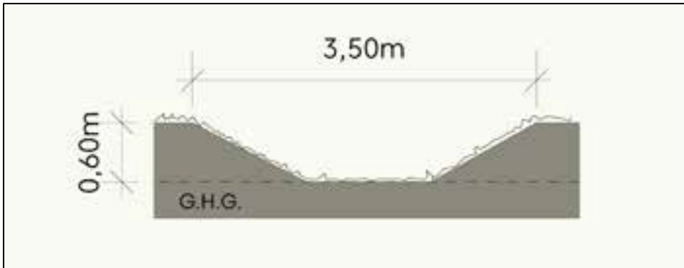
Afbeelding 7.1 Profiel nieuw te graven sloot (Bron: de Erfontwikkelaar)
