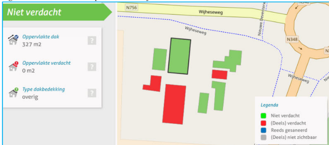
Figuur 5: asbestdakenkaart provincie Overijssel
