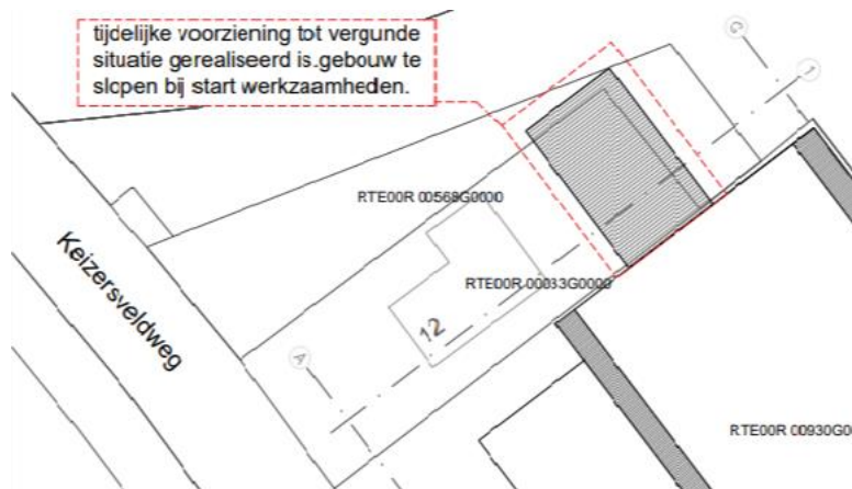
Te slopen tijdelijke voorziening voor opslag (rood gestippeld omlind)
