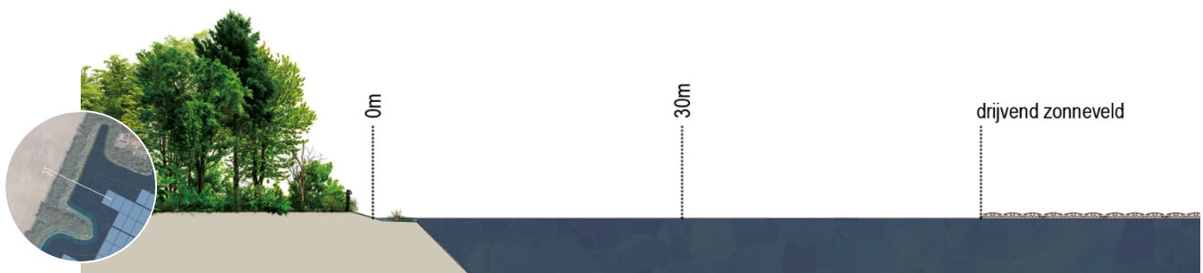
Principeprofiel A: panelen liggen hier op bijna 60m vanaf de waterkant
