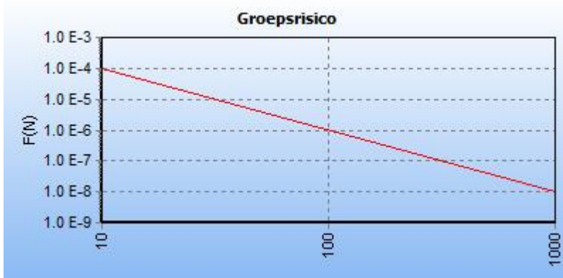
5.10 Figuur 5.10 FN curve voor 6412_leiding-A-588-deel-1 van N.V. Nederlandse Gasunie voor de kilometer tussen stationing 640.00 en stationing 1640.00
