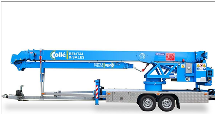
Voorbeeld van een lichte, mobiele kraan. Geschikt voor plaatsen dakpannen, dakplaten en gordingen.
