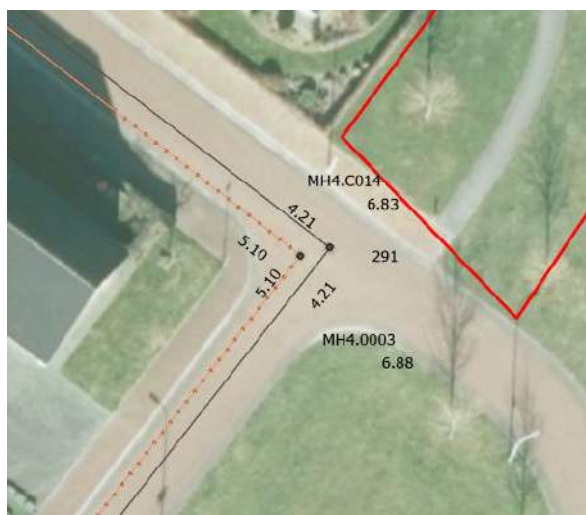
Figuur 19. Zuidoostelijke b.o.b. aansluitingen riool en drainage
