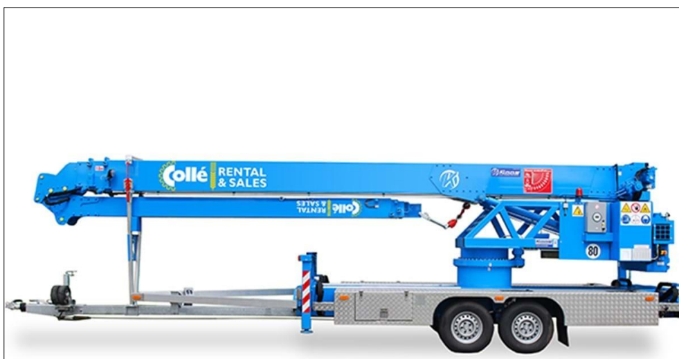
Voorbeeld van een lichte, mobiele kraan. Geschikt voor plaatsen wandplaten en sandwichpanelen
