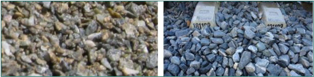
Figuur 29: Verschil kiezels (links) en breuksteen (rechts).
