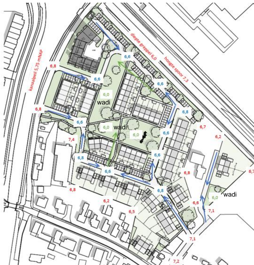
Figuur 12: Stedenbouwkundig plan met globaal de nieuwe hoogtes + afstroming hemelwater naar wadi's.
