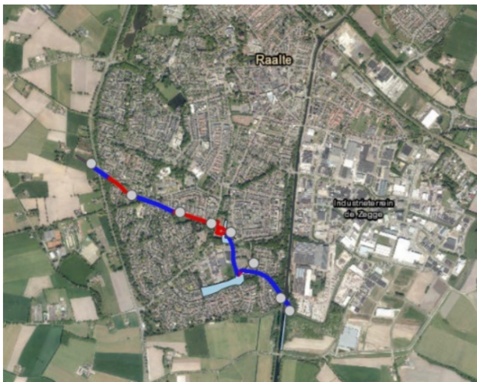
Figuur 1.1: Globale ligging van het tracé (rood= open ontgraving, blauw= HDD-boring, lichtblauw= uitlegstrook en de grijze stippen zijn de hoogspanningsmasten) (bron achtergrond: Esri).
