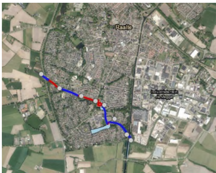
Figuur 2.1: Globale ligging van het tracé (rood= open ontgraving, blauw= HDD-boring, lichtblauw= uitlegstrook en de grijze stippen zijn de hoogspanningsmasten) (bron achtergrond: Esri).
