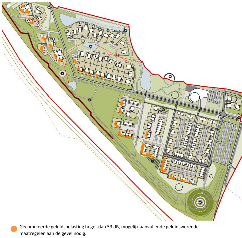
Figuur 10 Woningen waarbij de gecumuleerde geluidsbelasting afkomstig wegverkeerslawaai hoger is dan 53 dB in de huidige fysieke situatie van de N35 op de tweede verdieping
