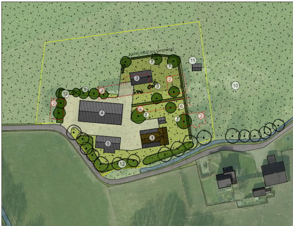
Afbeelding 2 Ligging plangebied Witteveensweg 15 Heeten (gele kader), te slopen bebouwing (rode stippellijn) en de nieuw te realiseren RvR-woning (nummer 3)
