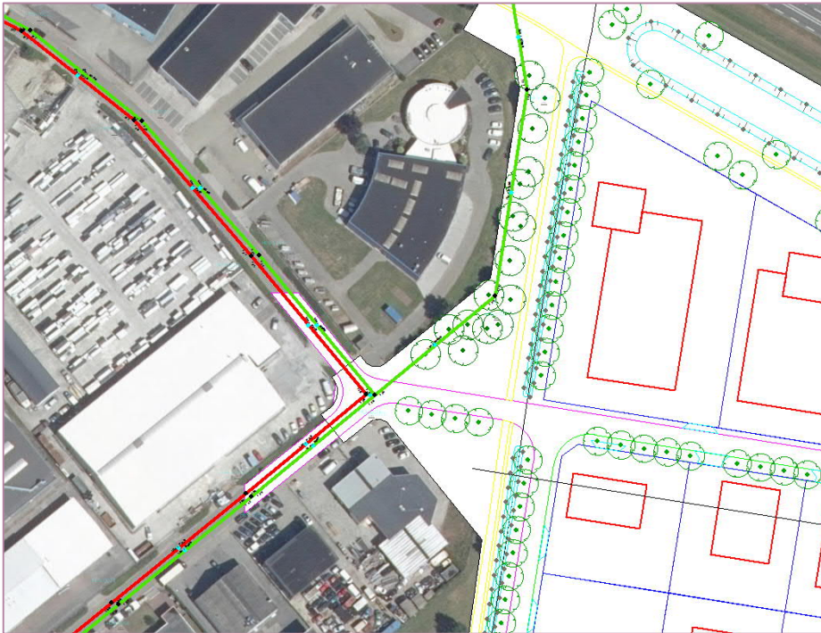
Figuur 2.7 Rioleringsituatie (bron: gemeente Raalte)
