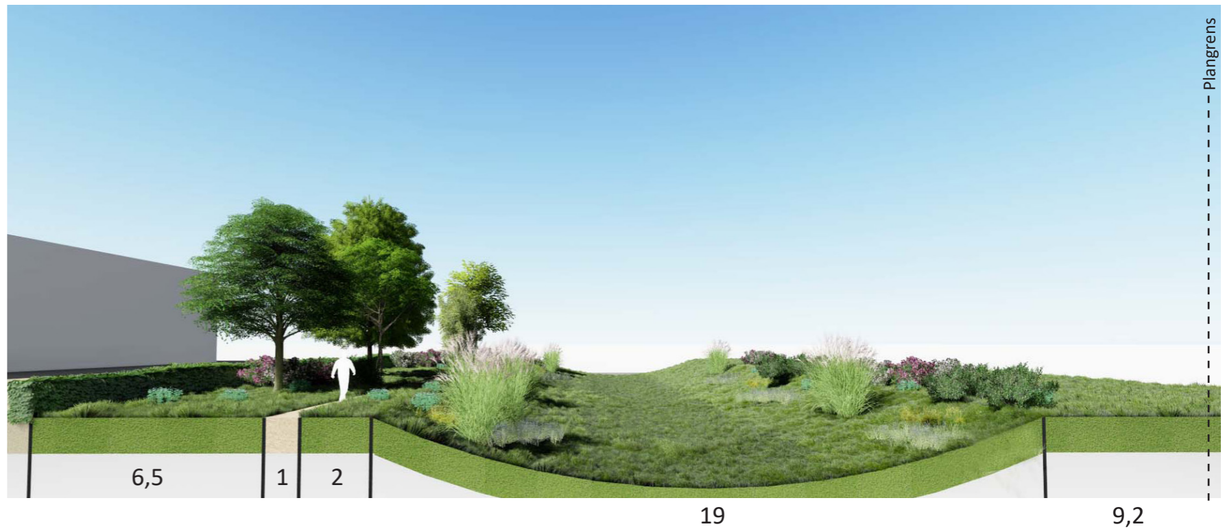
Doorsnede over noordelijke groenstrook: struinpad loopt meanderend tussen het bedrijventerrein en de waterberging (droogvallende wadi) de talud zijn flauw en worden ingericht met natuurvriendelijke oevers representatieve voorzuides van de bedrijven zijn op de N35 gericht
